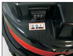
Uso Manual e Automático. A central liga e desliga com o uso da lixadeira.
